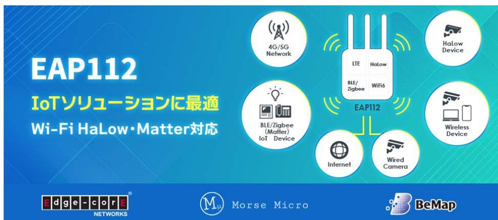
2024年9月発売予定の新製品、IoT機能を強化したWi-Fi6アクセスポイント「EAP112」を先行展示。「EAP112」はWi-Fi6/Wi-Fi HaLow/LTEなどの多様な通信と、matterゲートウェイ機能を搭載。さらにIP66等級の優れた耐候性を持ち、-30℃～50℃の温度下で動作。現在の日本国内で要求されるあらゆる無線通信の用途に応えることができ、これまで難しいとされてきた広い敷地や厳しい自然条件下の屋外施設でも、IoTソリューションの構築を可能とする製品です。
